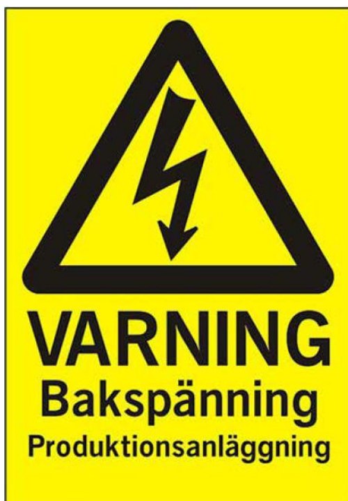
Bild 21. Exempel på skylt som varnar för bakspänning på anläggningen.
