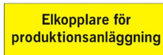
Bild 22. Exempel på skylt som utmärker elkopplare för produktionsanläggning.
