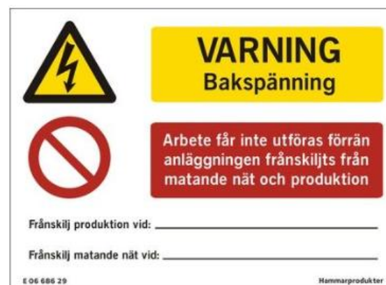
Bild 23. Exempel på skylt som varnar för bakspänning, används när elkopplaren inte sitter i mätarskåpet. Används främst vid strömtrafomätta anläggningar.
